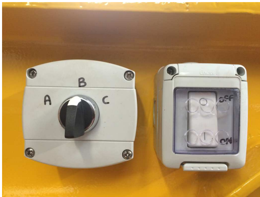
3 Way Toggle Switch & Trailer Light Switch (Manual).
